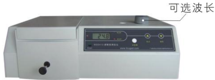
BGD 412 透明度测试仪
