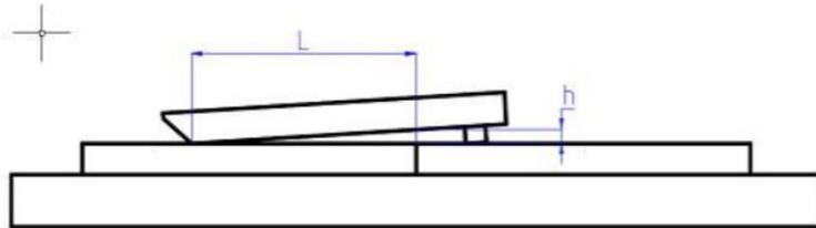
此遮盖力测定仪英文名 **Cryptometer**。底板一半黑、一半白, 黑的用于白色和浅色漆; 白的用于有色和深色漆, 并配有两块顶板, 常数分别为 K<sub>1</sub>=0.004 和 K<sub>2</sub>=0.008。通过仪器提供的换算表, 还可以得出每升多少平方米的平均数。
