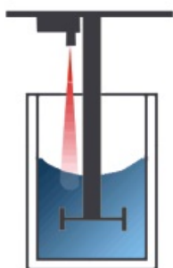
红外测温探头对物料温度监控
