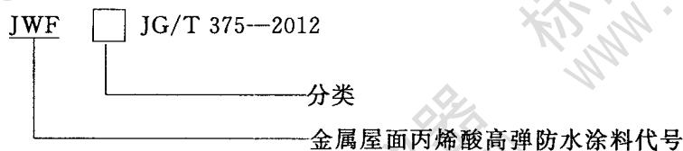
示例：热反射型金属屋面丙烯酸高弹防水涂料，标记为：JWF R JG/T 375—2012
